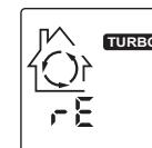
O Las flechas de RECIRC giran, rE parpadea y TURBO aparece para indicar recirculación a alta velocidad.
