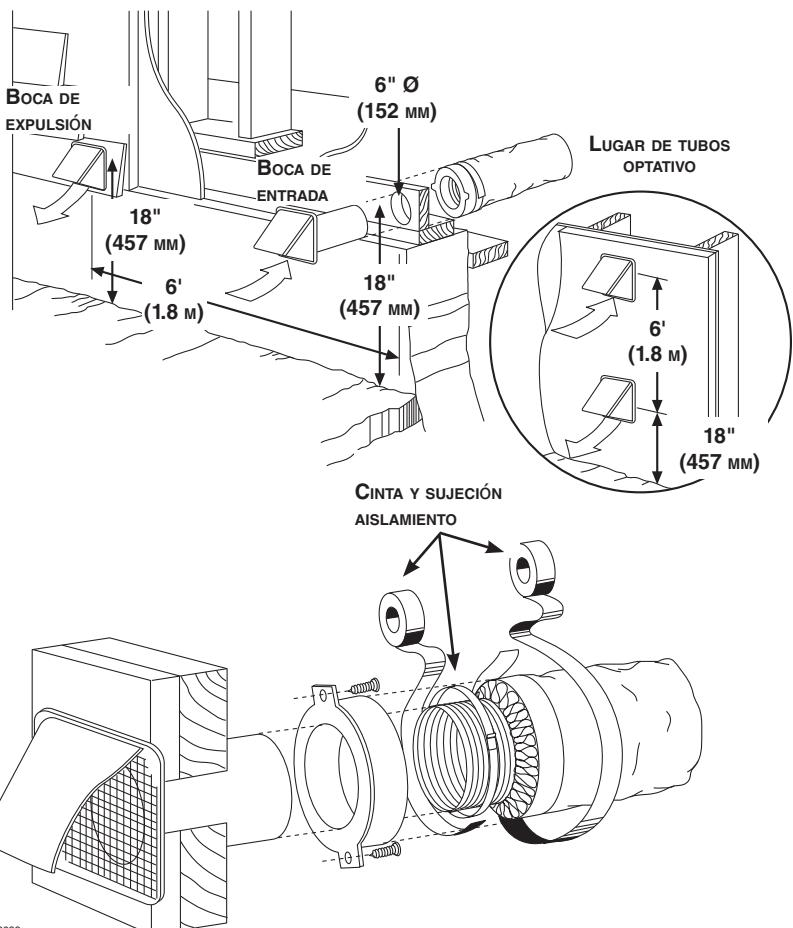
Véase la ilustración de la derecha para la conexión de los tubos flexibles aislados a los bocas exteriores. Una "boca de entrada con anti-ráfada" debe ser instalada en regiones donde baja mucha nieve.
