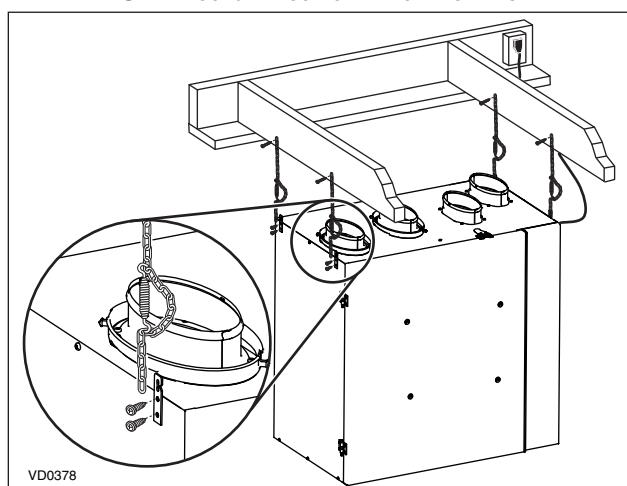
La unidad puede colgarse con las 4 cadenas y muelles provistos (véase la ilustración a la derecha) o colgarse de la pared con los soportes provistos (véase la página siguiente).
