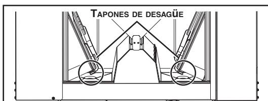
**NOTA:** Para modelos ERV, retire ambos tapones de desagüe que hay dentro del aparato antes de instalar los tubos.
