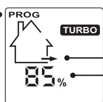
Esta sección de la etiqueta muestra la velocidad que se está seleccionando (p. ej., TURBO).
