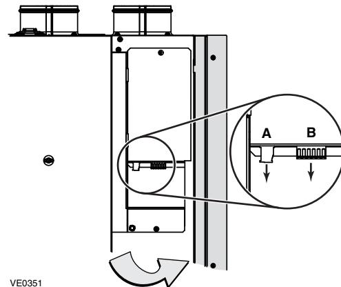
Pase el extremo del hilo o hilos de control a través del orificio situado en la pared de la unidad. Consulte la ilustración de la derecha (se ha suprimido de la imagen el tablero lateral para poder entender las instrucciones).
