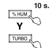
Presione simultáneamente durante 10 segundos las teclas % HUM y TURBO.
