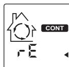
O Las flechas de RECIRC giran, rE parpadea, y CONT aparece para indicar recirculación a baja velocidad.
