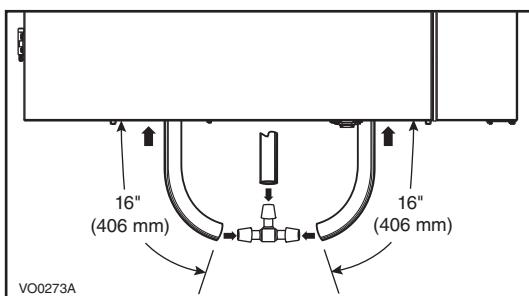
Corte dos secciones del tubo de plástico de una longitud mínima de 16" y conecte cada una de ellas con los desagües interiores situados debajo del aparato. Una ambas secciones cortas al empalme en "T" y al tubo principal, como se ve en la ilustración.
