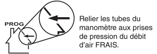
Relier les tubes du manomètre aux prises de pression du débit d'air FRAIS.
