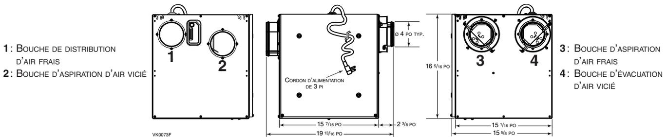
NOTE : TOUTES LES BOUCHES DE L'APPAREIL ONT ÉTÉ CONÇUES POUR ÊTRE RACCORDÉES À DES CONDUITS D'UN MINIMUM DE 4 PO DE DIAMÈTRE, MAIS SI NÉCESSAIRE, ELLES PEUVENT ÊTRE RACCORDÉES À DES CONDUITS DE FORMAT PLUS GRAND EN UTILISANT UNE TRANSITION ADÉQUATE (EX.: TRANSITION DE 4 PO À 5 PO DE DIAMÈTRE).
