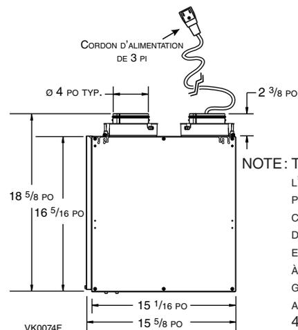
NOTE: TOUTES LES BOUCHES DE L'APPAREIL ONT ÉTÉ CONÇUES POUR ÊTRE RACCORDÉES À DES CONDUITS D'UN MINIMUM DE 4 PO DE DIAMÈTRE, MAIS SI NÉCESSAIRE, ELLES PEUVENT ÊTRE RACCORDÉES À DES CONDUITS DE FORMAT PLUS GRAND EN UTILISANT UNE TRANSITION ADÉQUATE (EX.: TRANSITION DE 4 PO À 5 PO DE DIAMÈTRE).
