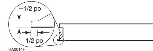
**NOTES:** 1. Nous recommandons que la base de l'armoire soit faite en contreplaqué de 3/4 po d'épaisseur. Nous recommandons que l'épaisseur de l'arrière (le cas échéant), de l'avant et des côtés de l'armoire soit de 3/4 po. La PROFONDEUR INTÉRIEURE indiquée dans le tableau ci-dessus sous-entend que l'épaisseur minimale de l'arrière de l'armoire est de 3/8 po.
